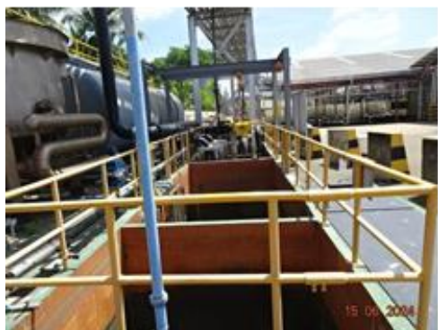
ภาพที่ 7 บ่อดักคราบน้ำมัน (Oil interceptor)
